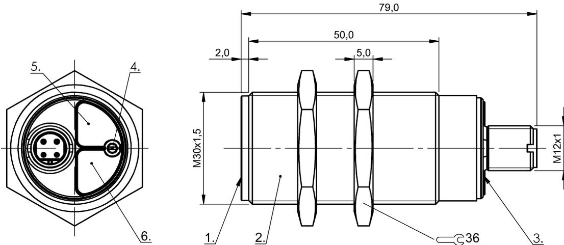
1) Superficie attiva 2) Carcassa 3) Coperchio 4) Potenzimetro 5) Tensione d'esercizio LED 6) Indicatore di funzione LED
