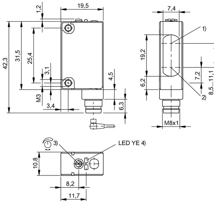
1) Asse ottico ricevitore 2) Asse ottico emettitore 3) Sn 4) Funzione in uscita
